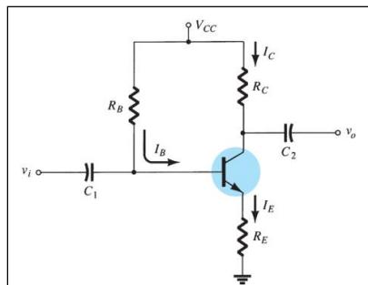
$$V_{CE} = V_{CC} - I_C R_C - V_E$$
